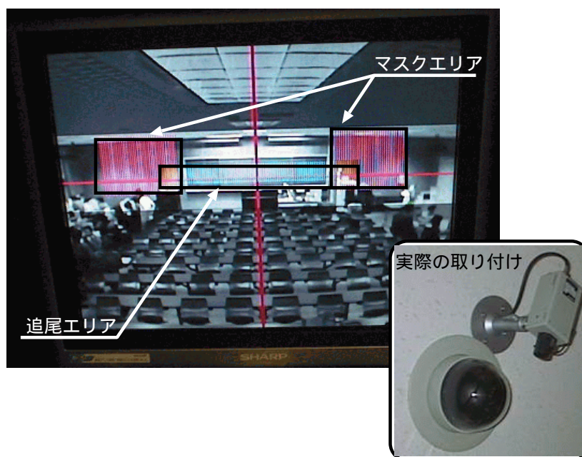
図 6: 自動追尾カメラ撮影システムの設定例 (AV 講義室)
