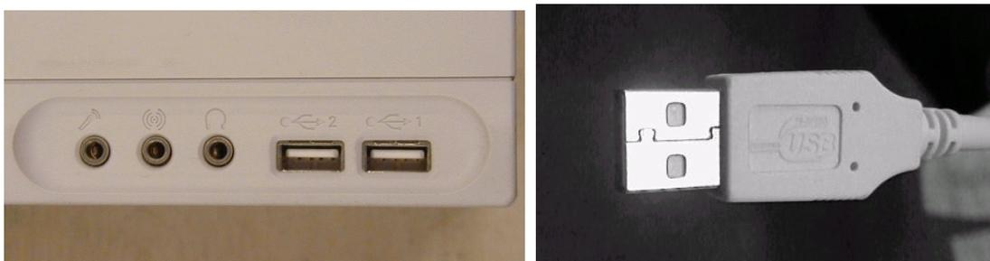
図 2: USB コネクタ (PC 側，メス)(左) と USB コネクタ (周辺機器側，オス)(右)
